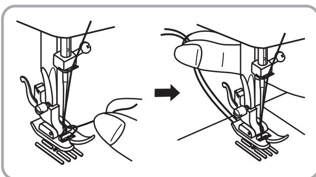
Zatáhněte za svrchní niť tak, aby se spodní niť povytáhla z otvoru na destičce pro jehlu. Stáhněte obě nitě dozadu pod přitlačnou patkou.
