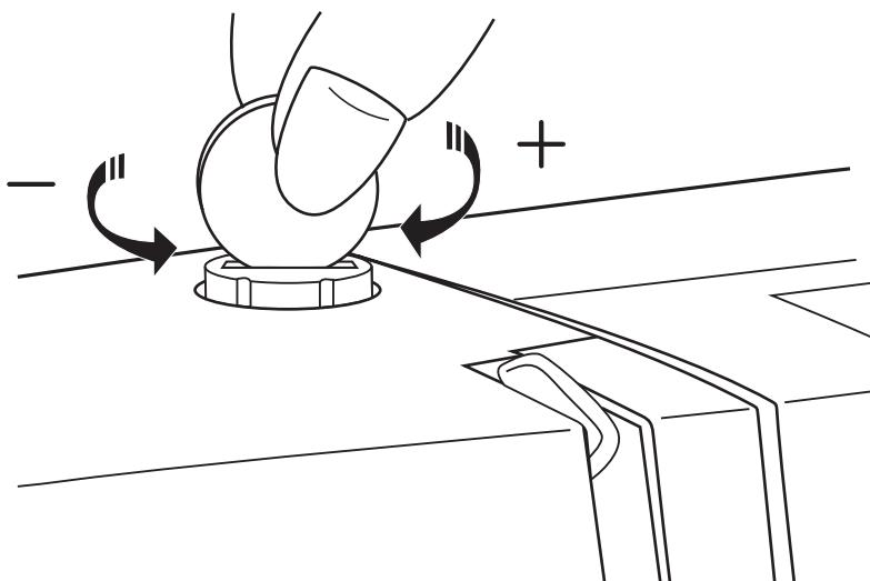
Tlak přítlačné patky šicího stroje byl přednastaven a nevyžaduje žádnou úpravu v závislosti na použité látce (lehká látka nebo látka těžká). Potřebujete-li nicméně nastavit tlak přítlačné patky, otočte seřizovacím šroubem pomocí mince.
