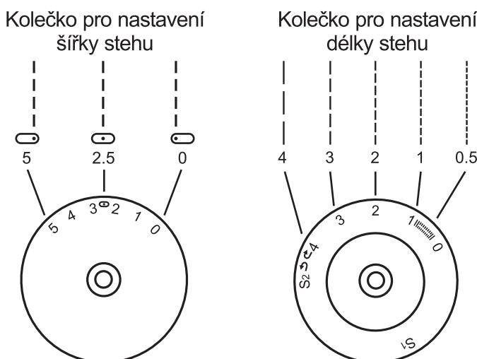
Otočte voličem tak, aby se v okýnku pro zobrazení stehu objevil steh rovný ("A").
