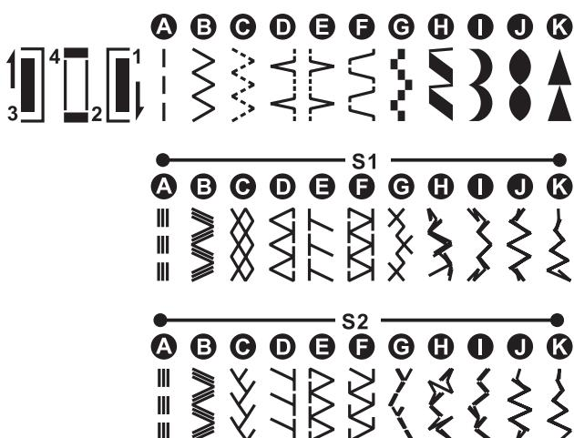
**Rovné stehy:** otočte voličem stehů na požadovaný symbol nebo tak, aby se v okýnku objevilo písmeno " | ". Nastavte polohu jehly vlevo nebo vpravo otáčením voliče šířky stehu. Nastavte délku stehu pomocí voliče stehů.
