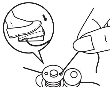
**Poznamenejte si:** Je-li osička navíječe v poloze "navíjení člunku", stroj nemůže šít a setrvačník se neotáčí. Chcete-li začít šít, zatlačte na osičku navíječe směrem doleva (poloha pro šití).
